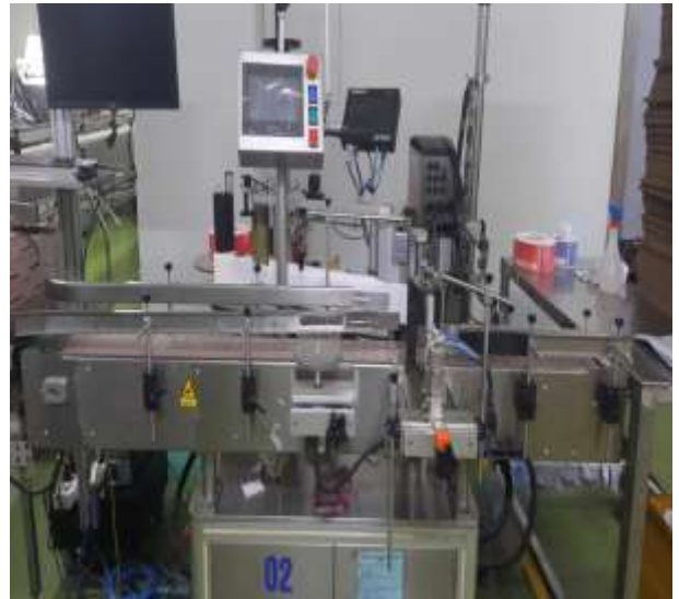
Hệ thống đóng gói tự động
